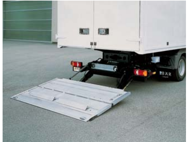
Cargolift в рабочем положении, специальное оборудование – защита от скатывания
